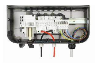
/ Das DC Connector Kit ermöglicht das Bügeln der beiden Eingänge bei MPP-Strömen über 35 A und einem Kabelquerschnitt über 16 mm², zum Beispiel bei Verwendung einer DC Box. Mit dem Einsatz des DC Connector Kits kann ein Querschnitt von 6 mm² bis 25 mm² angeschlossen werden. Die Klemme ist berührsicher aufgebaut. Das DC Connector Kit eignet sich speziell zur Verwendung mit Fronius Symo 10.0 – 20.0 kW und Fronius Eco Wechselrichtern.
