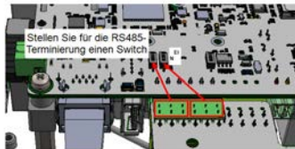
Abbildung 18: RS485-Terminierungs-Switch am Wechselrichter
