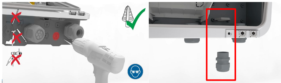
Abbildung 3: Durchbohrung der Grundschaube und eingesetzte PG-Verschraubung an der durchbohrten Stelle
