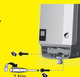
Atornillar el inversor siempre mediante los tornillos de fijación, según el par indicado en el manual de instrucciones, firmemente al soporte mural. ¡Poner el inversor exclusivamente en servicio con los tornillos de fijación correctamente apretados!
