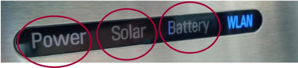
**LED am Wechselrichter:**
