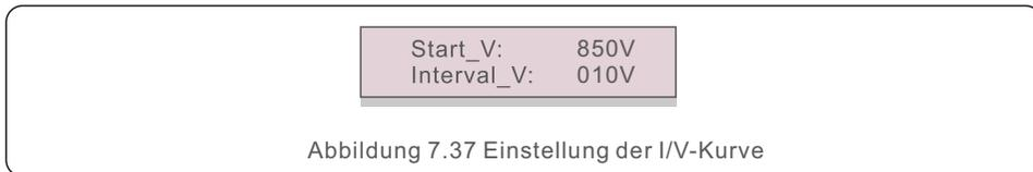
Start\_V: Die Startspannung für den I/V-Scan. (Einstellbar von 100V-1100V)
