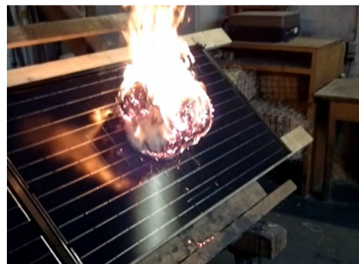
Abbildung 1: Prüfung Widerstand gegen Flugfeuer und strahlende Wärme
