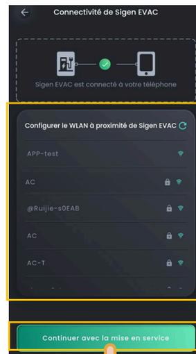
Si l'installateur choisit de connecter l'équipement au point d'accès WLAN dans les locaux du propriétaire, se connecter au point d'accès disponible pour accéder à la page Créer un nouveau système puis effectuer les opérations en se référant à la section « Déjà connecté à Internet ».
