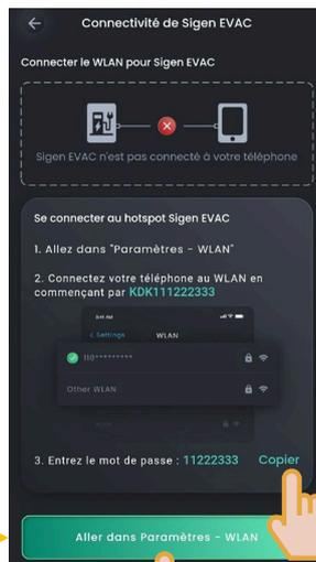
Se connecter au point d'accès WLAN de l'équipement. Le point d'accès est nommé avec le numéro de série de l'équipement et le code d'accès est indiqué sur l'interface utilisateur.
