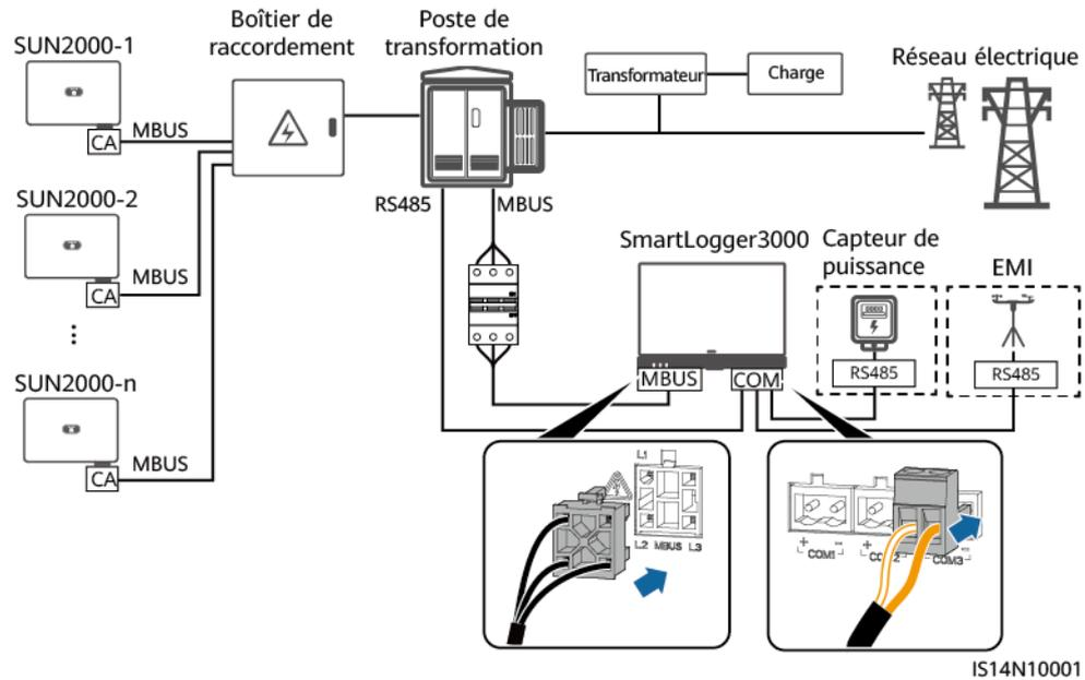
**Figure 5-23** Communication MBUS (scénarios commerciaux et industriels en Chine)
