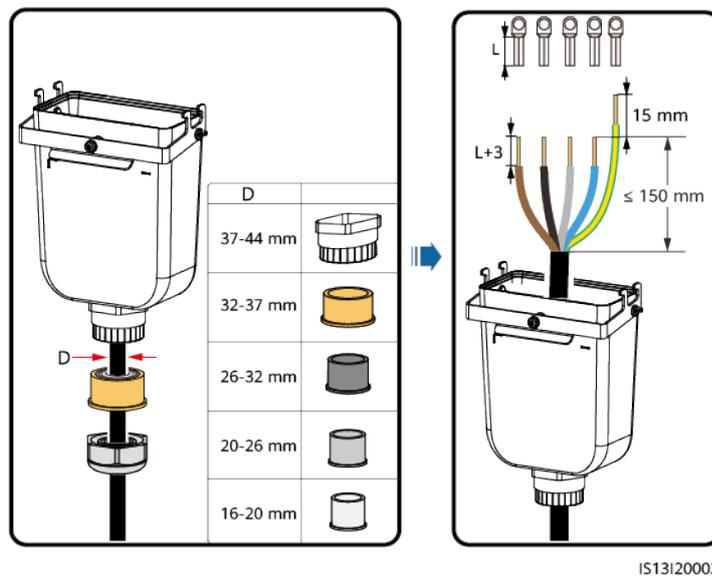
Figure 5-6 Câble à cinq conducteurs (L1, L2, L3, N et PE)
