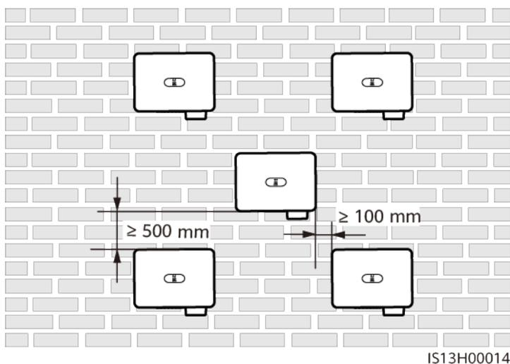
**Figure 4-6** Installation empilée (non recommandée)
