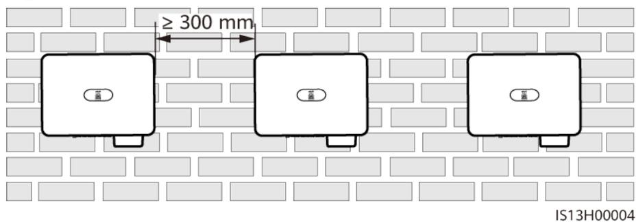
**Figure 4-4** Installation en triangle à deux couches (recommandée)
