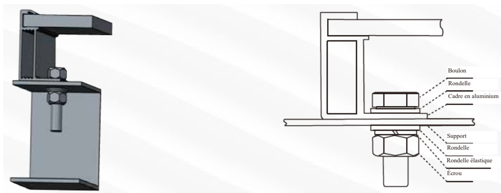
Figure 5 Installation de boulons des modules monofaciaux
