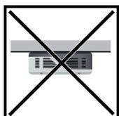
Non montare Fronius Ohmpilot sul soffitto.
