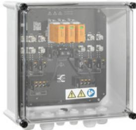
I combiner box fotovoltaici successivi per inverter con 1-12 tracker MPP sono utilizzati per proteggere il lato DC di un sistema fotovoltaico. I combiner box proteggono l'inverter dalle sovratensioni e sono quindi conformi alla direttiva europea EN 51543-32. Inoltre, questi prodotti offrono la possibilità di proteggere il sistema dalle correnti invertite e di combinare stringhe per garantire un risparmio di cavi durante l'installazione.
