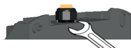
Fig. 6-15: Serrare il passacavo a vite dal retro
