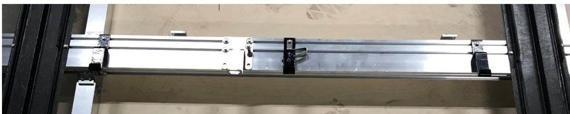
3. Avvitare il dispositivo di ancoraggio con 4 viti a testa semisferica da 8 x 40 mm. Entrambi i fori inferiori del dispositivo di ancoraggio non vengono utilizzati per la sottostruttura in alluminio.
