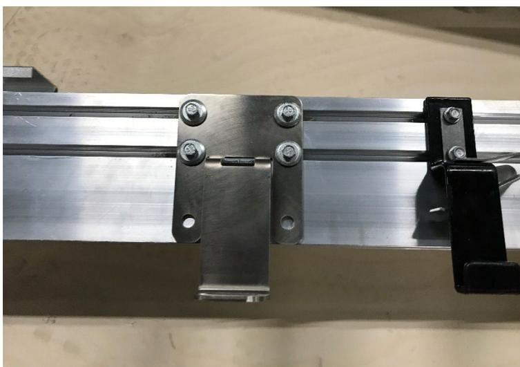
Immagine 10 dispositivo di ancoraggio montato
